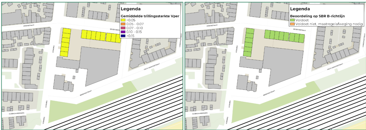
Figuur 8 Gemiddelde trillingssterkte V_{per} (links) en beoordeling op SBR B-richtlijn (rechts)
