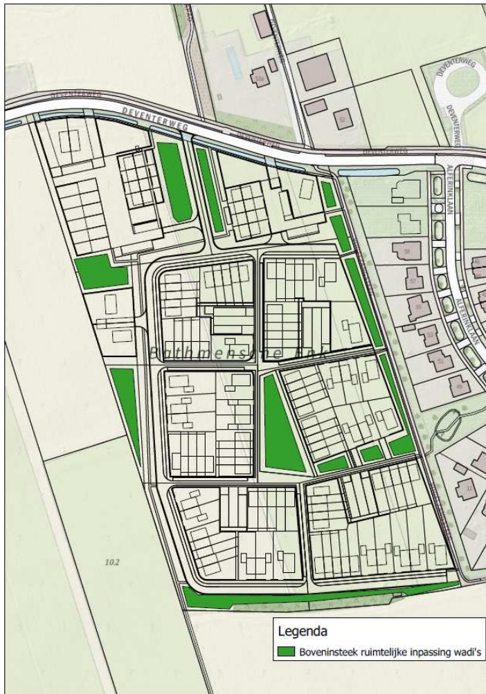
Figuur 4: Boveninsteek ruimtelijke inpassing wadi's
