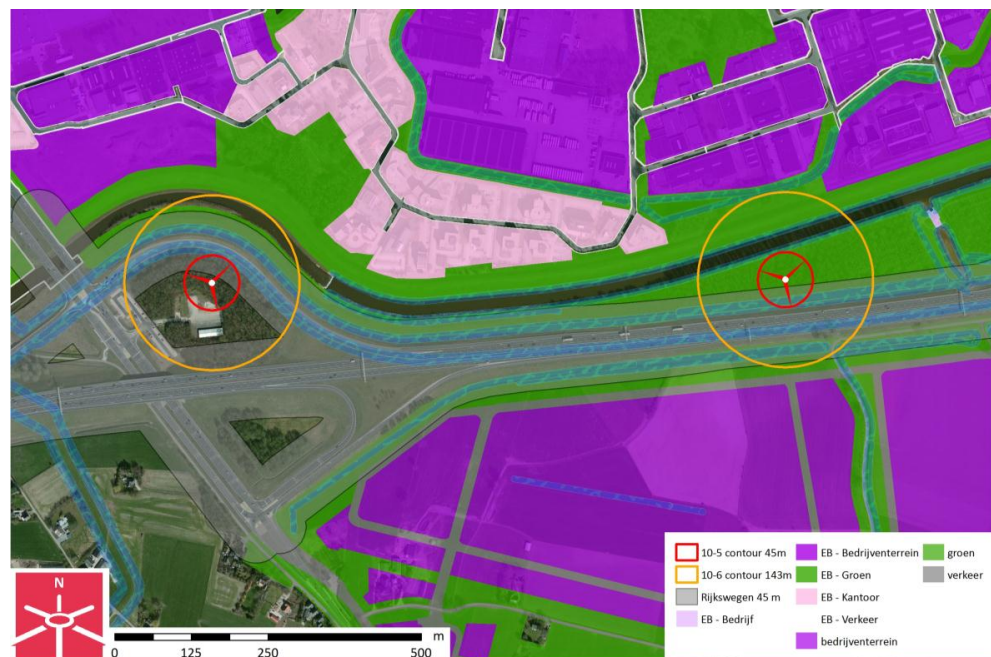
Figuur 3: De maximale risicocontouren van de geplande windturbines
