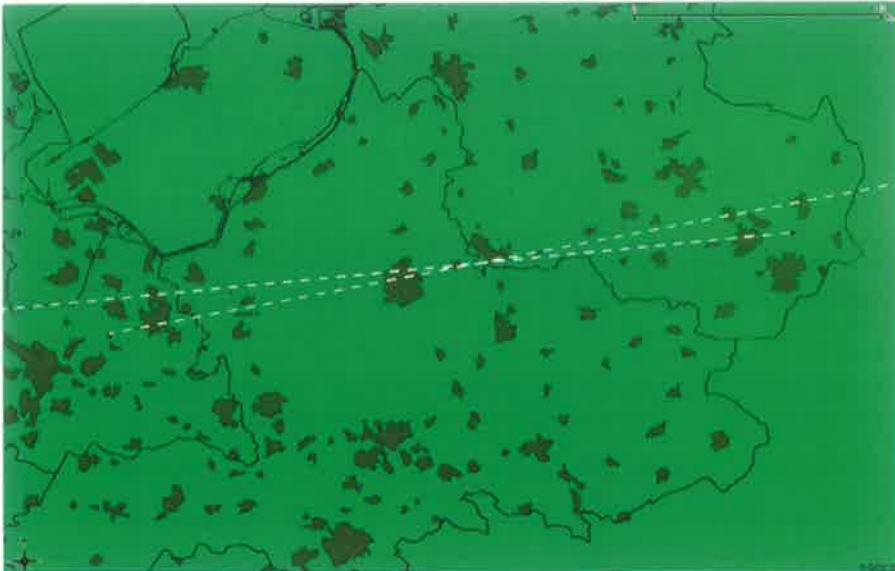
Figuur 8 Detectiekans van de MASS verkeersleidingsradarketen op 1000 voet in het schaduwgebied van het bouwplan voordat deze is gerealiseerd (baseline).
