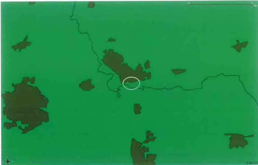
Figuur 6 Detectiekans MASS primaire verkeersleidingsradarketen op 1000 voet boven en in de nabijheid van het bouwplan nadat deze is gerealiseerd. Op dit figuur is detectiekansmiddeling toegepast.
