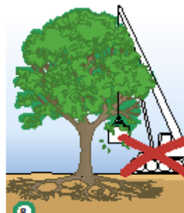
8 Werk met bouwmaterialen waar mogelijk buiten de kroonprojectie en gebruik aan de omgeving aangepast materiaal. Hiermee wordt onnodige schade aan de boom voorkomen.
