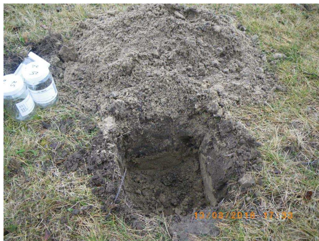
Foto 20: asbestgat bij boornummer 25
