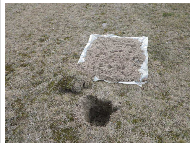
Foto 3: asbestgat bij boornummer 4
