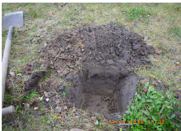
Foto 16: asbestgat bij boornummer 16
