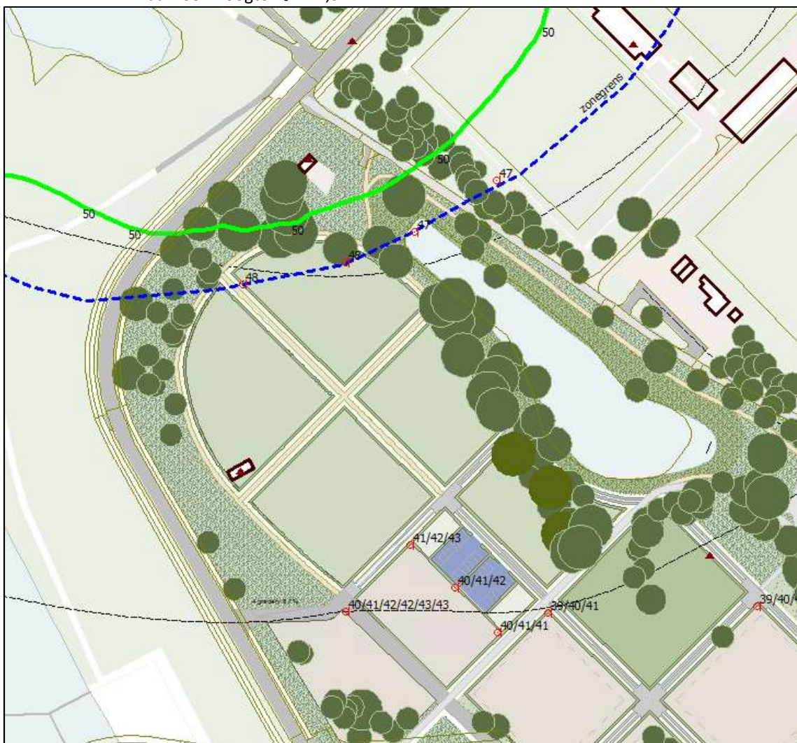
Figuur 8.1: berekende 50 dB(A) etmaalwaarde-contour op basis van de vergunning RWZI, waarneemhoogte h_o = +7,5 m
