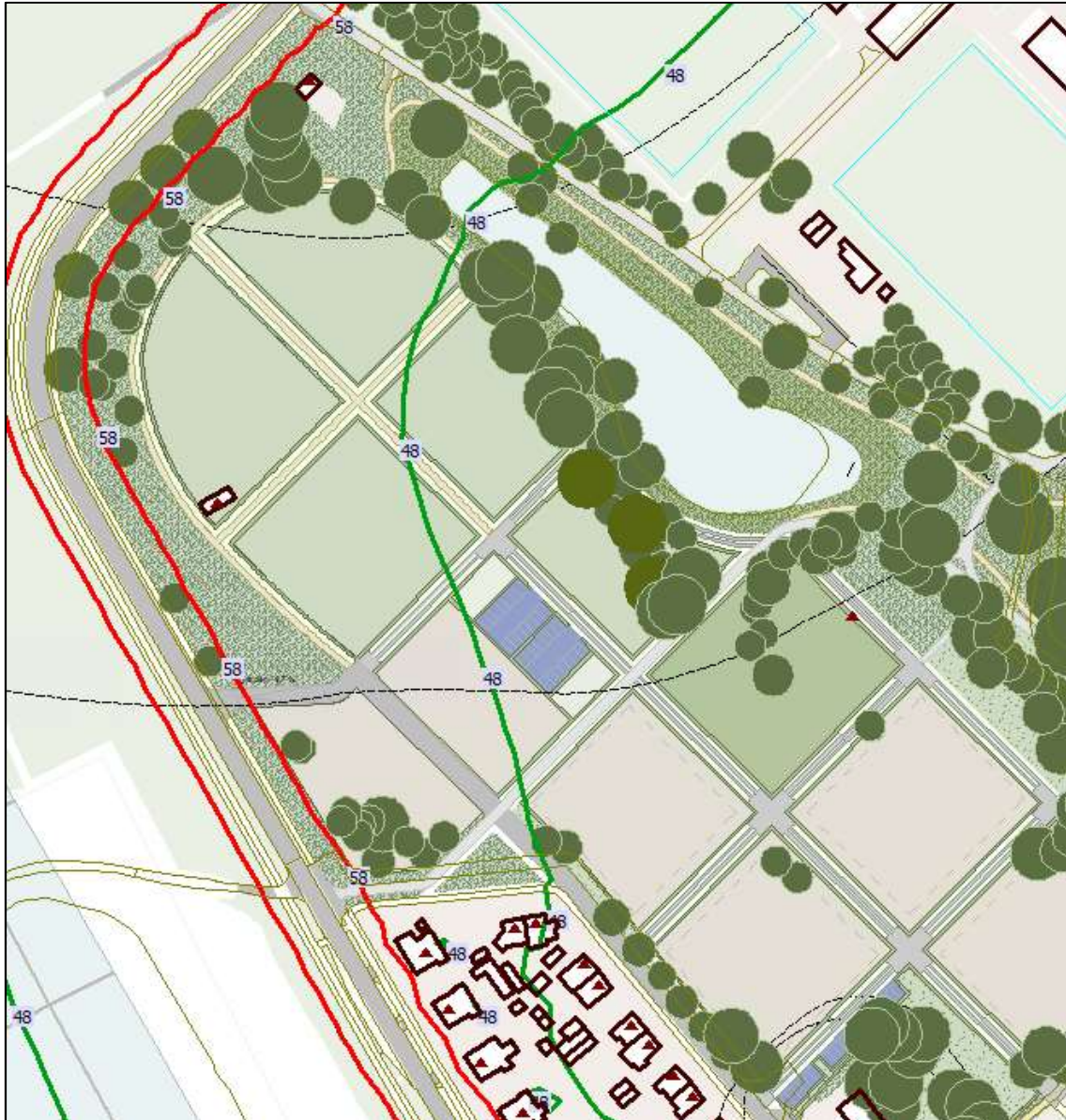
Figuur 8.6: berekende 48/58 dB L_{den} geluidscontouren vanwege de Rembrandtkade/Roland Holstlaan op een waarneemhoogte h_o = +4,5 m (inclusief aftrek art. 110g Wgh)
