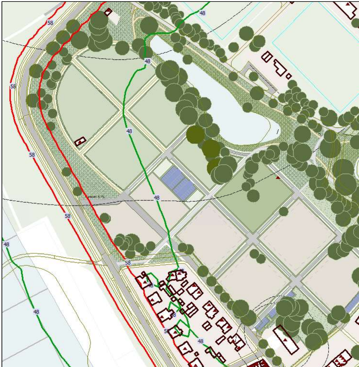
Figuur 8.5: berekende 48/58 dB L_{den} geluidscontouren vanwege de Rembrandtkade/Roland Holstlaan op een waarneemhoogte h_o = +4,5 m (inclusief aftrek art. 110g Wgh)
