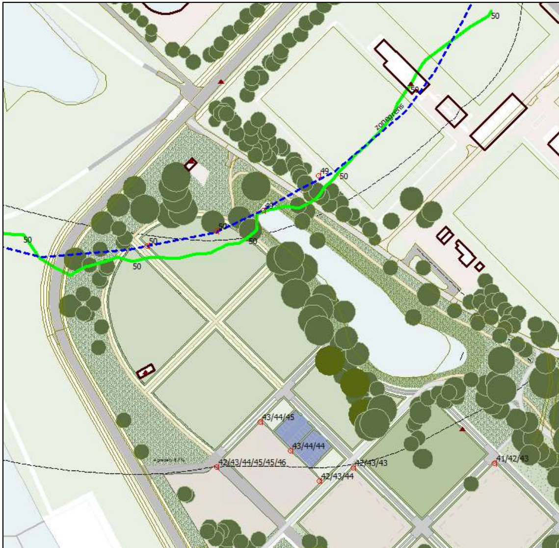
Figuur 8.2: berekende 50 dB(A) etmaalwaarde-contour op basis van maximaal planologische situatie vanwege de RWZI, waarnemhoogte h_o = +7,5 m
