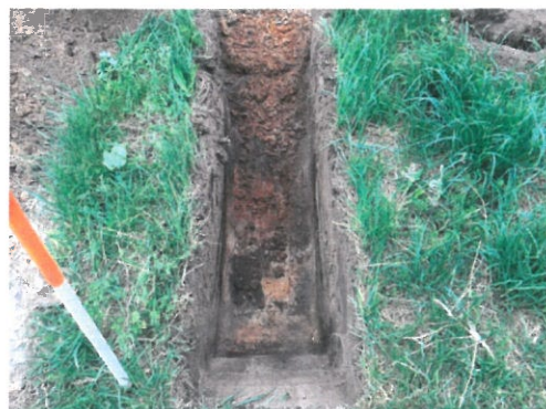
Foto 3.2: Sleuf 2 0-0,5 m –mv (grond)
