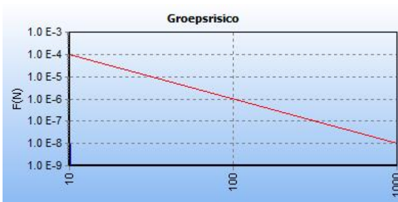
Afbeelding 6 fN-curve buisleiding A-651-deel-1, huidige situatie
