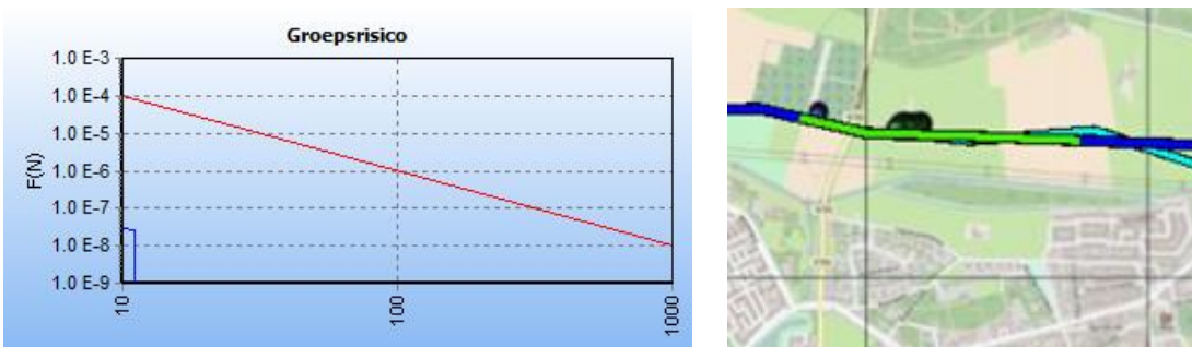
Figuur 6 FN-curve van de kilometer met de hoogste overschrijdingsfactor van gastransportleiding A-651 in de huidige situatie. De ligging van deze kilometer is hiernaast in het groen weergegeven op een topografische kaart.
