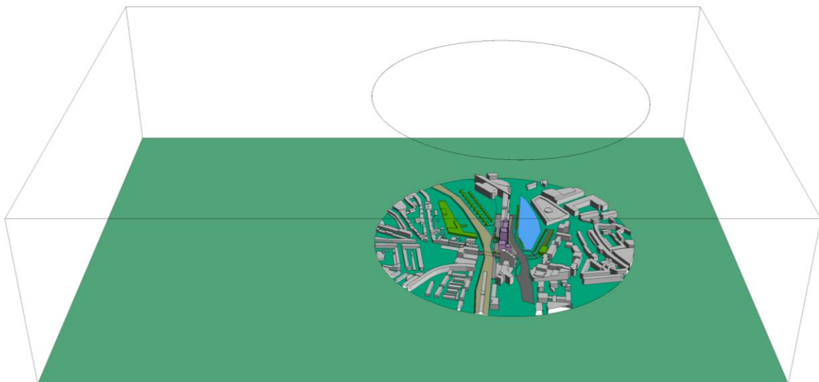
Figuur 8: Box om het gemodelleerde gebied heen, ten behoeve van het windprofiel (digitale windtunnel).
