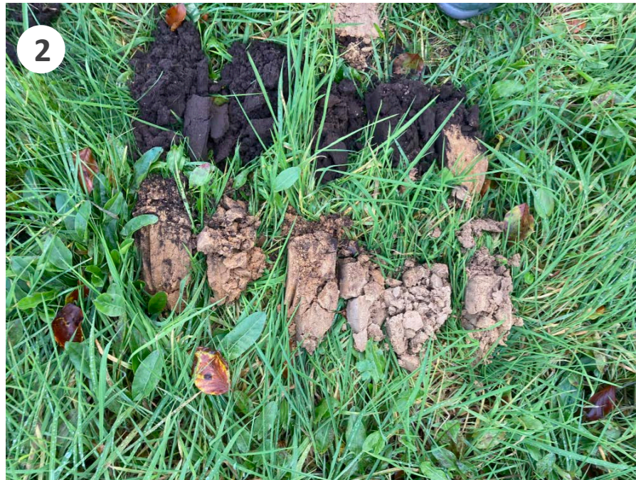
Boring 2: Minder lemig, doorlatend. Donkere grond in de ploegvoor (circa 35 cm). Grondwater zit op meter diepte.
