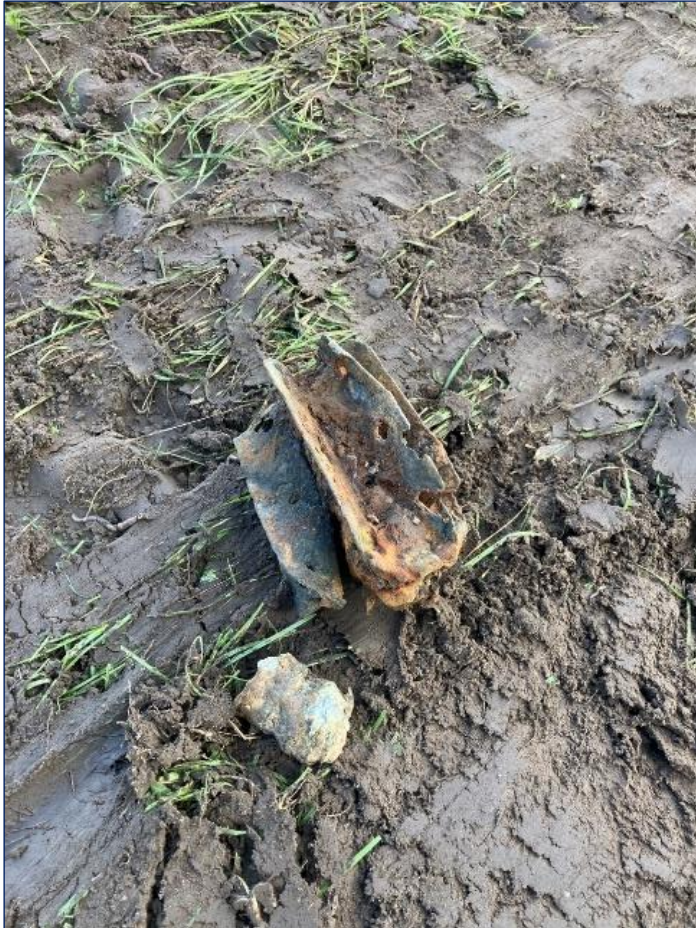
Figuur 5 Staartstuk 4.2inch mortier met restant schokbuis No 152/162
