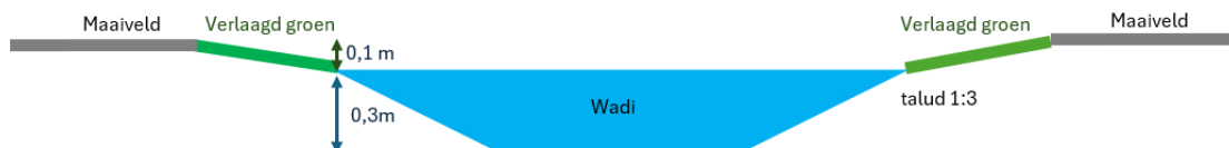
Figuur 4.2 Conceptueel dwarsprofiel van de wadi aangelegd in verlaagd groen voor extra berging tijdens een T=100 bui
