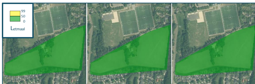
Figuur 4 Beoordeling grenswaarden Bruidsschat op 2,0 meter (links), 5,0 meter (midden) en 8,0 meter (rechts)
