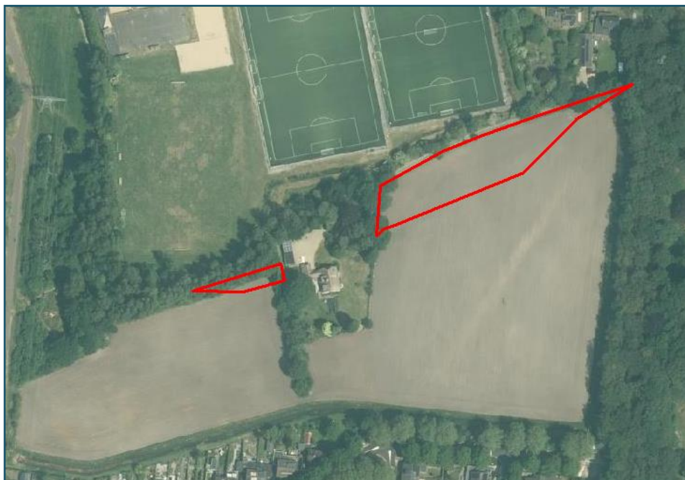
Figuur 12 Totaalweergave van de afstanden die aangehouden moeten worden om te voldoen (5,0 meter beoordelingshoogte)
