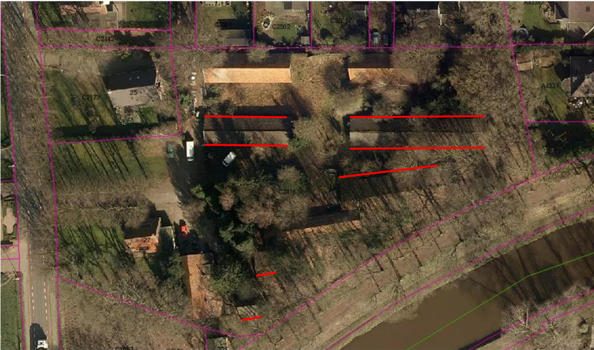
Afbeelding 1: Situering onderzoekslocatie op luchtfoto (bron Omgevingsdienst IJsselland). De asbestverdachte daklijnen (vermoedelijk asbestdak zonder dakgoot) zijn aangegeven middels rode lijnen.
