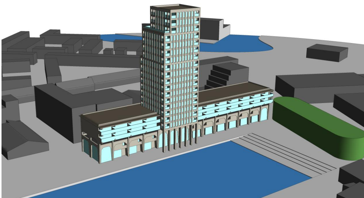
Figuur 1: Overzicht van de nieuwbouwontwikkeling in het 3D CFD model.
