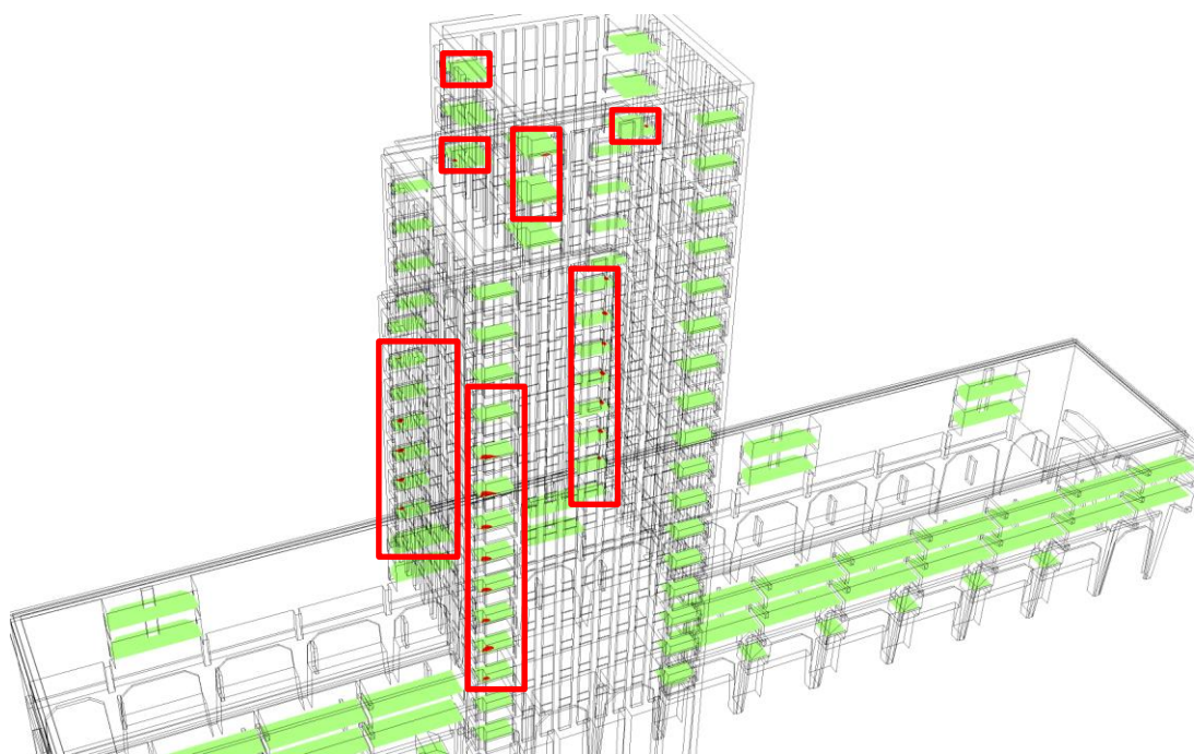
Figuur 13: Windgevaar per jaar op 1 meter boven de loggia's zonder vouwwanden. Rood geeft windgevaar aan.
