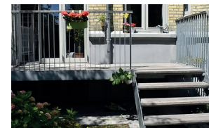
4.1.a. Voorbeeld van een leefgalerij: ruimte voor de woning om een stoel en tafel te plaatsen ligt los van de vluchtroute - LEVS architecten
