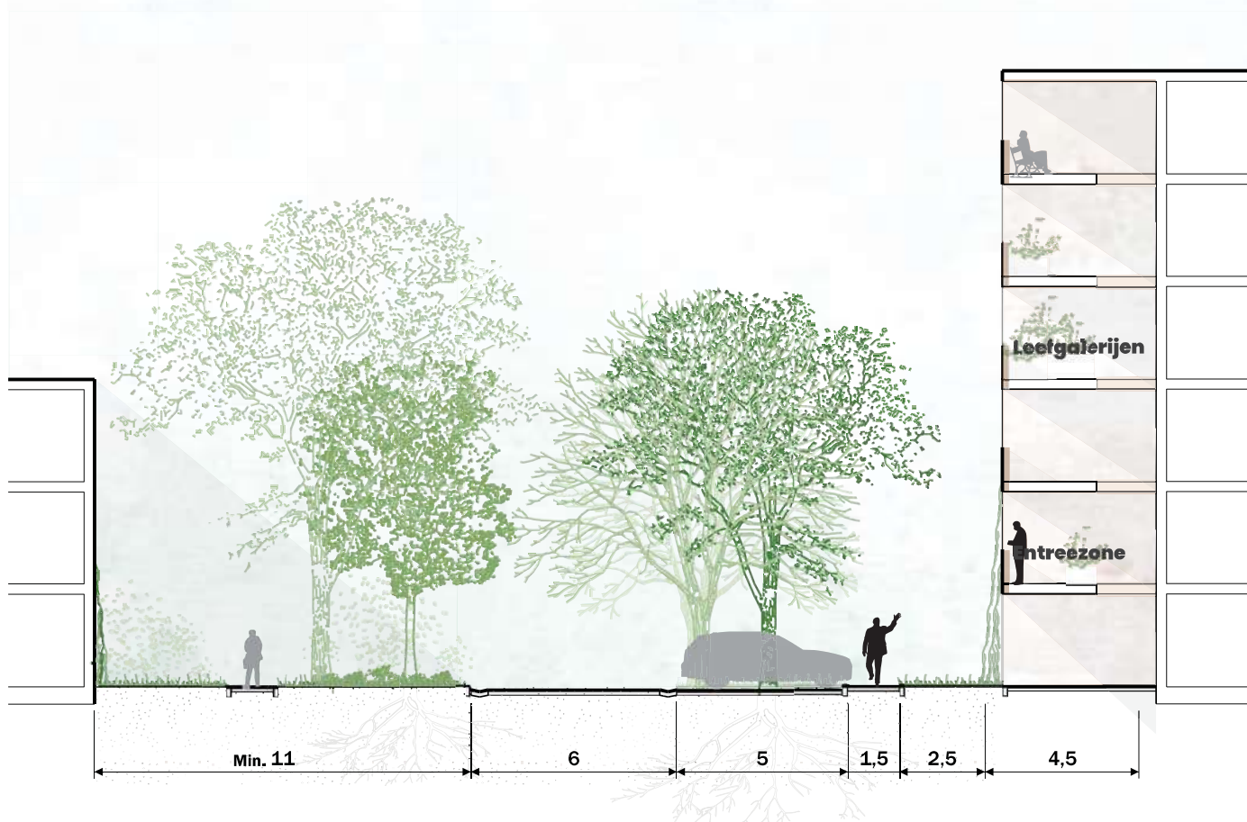
Basisprofiel ontsluitingsstraat (schaal 1:200) - maatvoering indicatief
