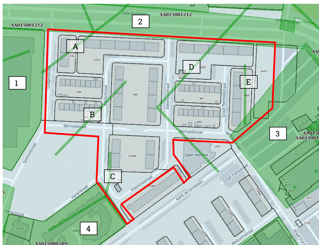
De onderzoeken nabij de onderzoekslocatie zijn in bovenstaande figuur genummerd en worden hieronder in de tabel beschreven. De groene lijnen betreffen de gedempte sloten A t/m E die in hoofdstuk 2.4 (Historie) beschreven zijn. (bron: overijssel.omgevingsrapportage.nl)
